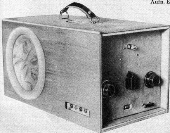
Ein Allstrom-Einkreifer, der von einem tüchtigen Bafler für den Betriebsfunk gebaut worden ist. Das Gerät ist also nur für Orts Empfang, enthält aber dynamischen Lautsprecher.
